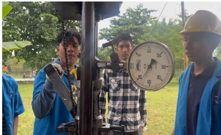
**Gambar 3.** Demonstrasi alat uji tanah *sondir / CPT*
