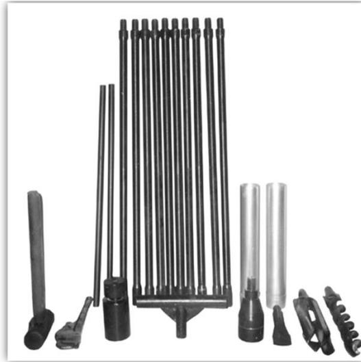
**Gambar 6.** Peralatan alat uji tanah hand bor
