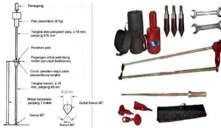
**Gambar 4.** Peralatan alat uji tanah DCP
