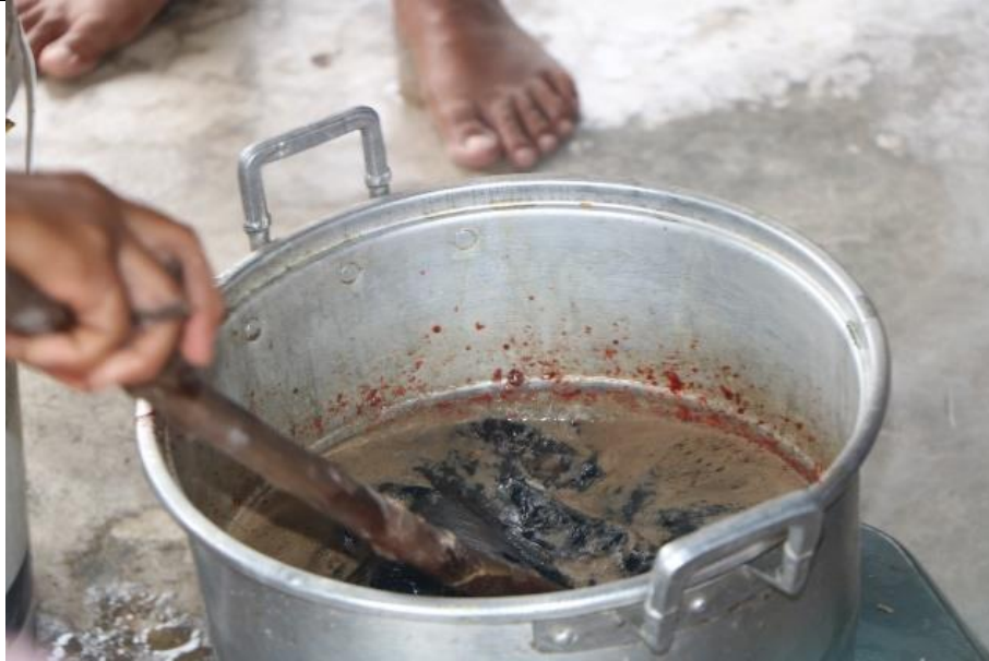
Gambar 8. Pelorotan Lilin dengan Menggunakan Air Panas Agar Lilin Tersebut Hilang
