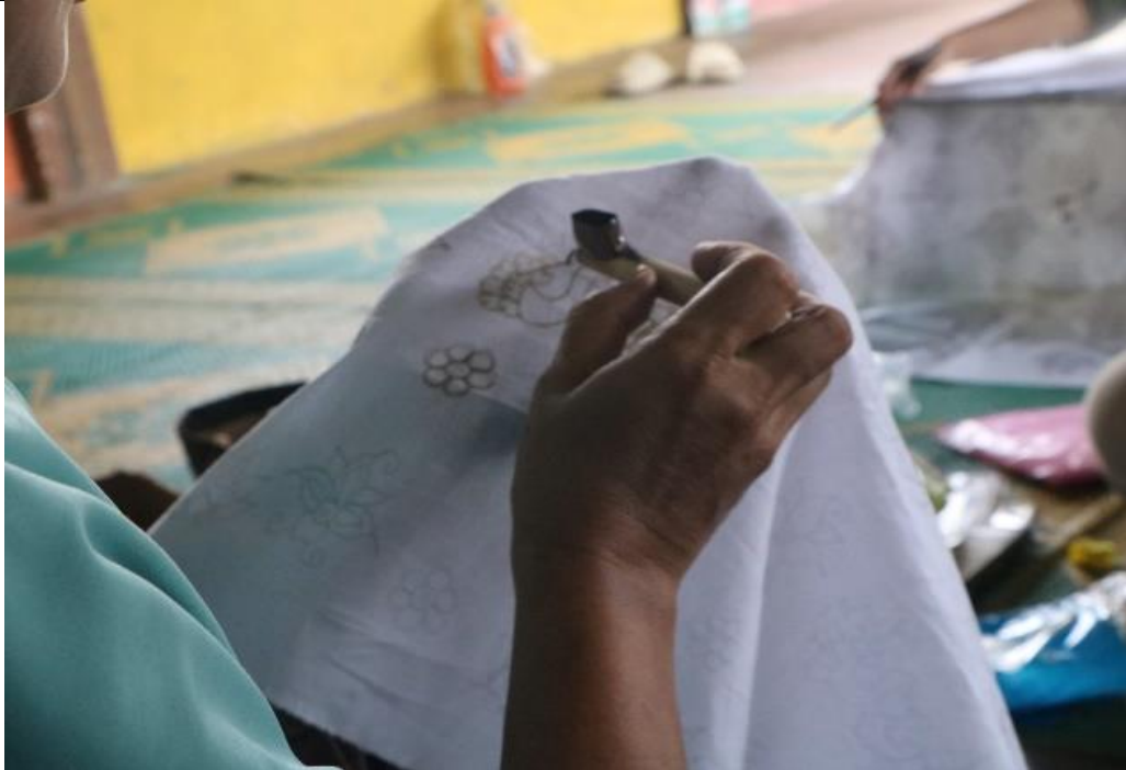
Gambar 3. Penorehan Lilin dengan Menggunakan Canting di Atas Kain
