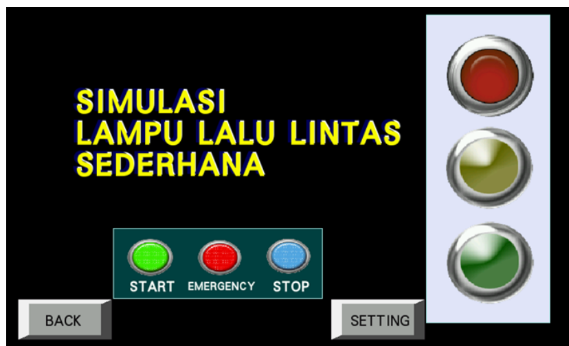
Gambar 4. Desain HMI Simulasi Lampu Lalu Lintas Menggunakan NB-Designer
