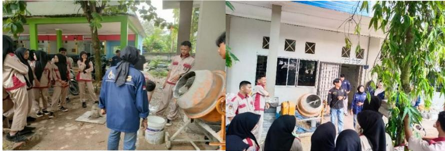
**Gambar 4.** Pembuatan sample beton K 250
