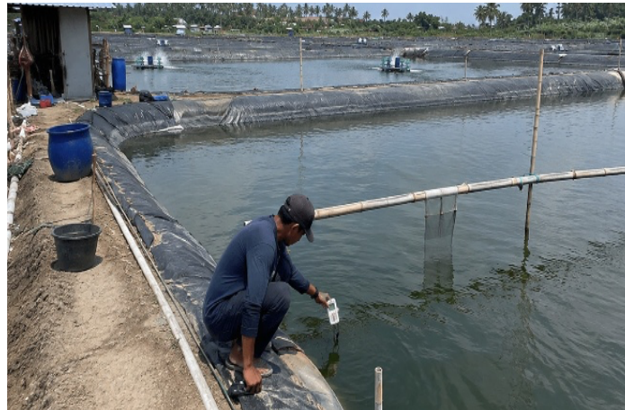
Gambar 2. Kondisi Saat ini dalam pengambilan data DO di Tambak menggunakan alat DO secara Manual di Lancang Barat Kecamatan Dewantara Aceh Utara
