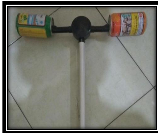
Gambar 3. Pembuatan antenna dari kaleng bekas
